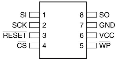
Figure 1-2. UDFN Top View<sup>(1)</sup>
